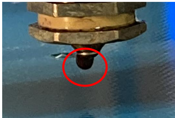
Abbildung 14 – Klebstoffansammlungen an der Düsenspitze
