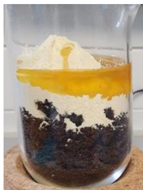
Abbildung 36: Mischung aus Stärkemischester, Kolophonium und Öl bei t = 0 min und T = \text{RT} .
