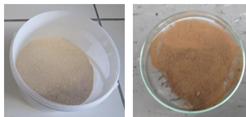
Abbildung 13: Mittels in-situ Reaktion im Process 11 hergestelltes Weizenstärkeacetobutyrate BIGL\_no\_118 (links) und Weizenstärkebutyrat BIGL\_no\_120 (rechts)
