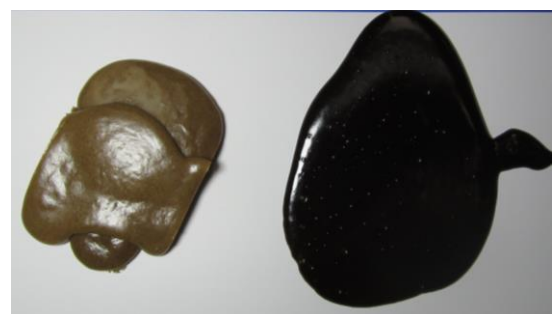
Abbildung 7 – Vergleich des BioGlyk-Versuchsmaterials: Frisch aufgeschmolzen vs. ca. 7 Stunden auf Verarbeitungstemperatur (170°C)
