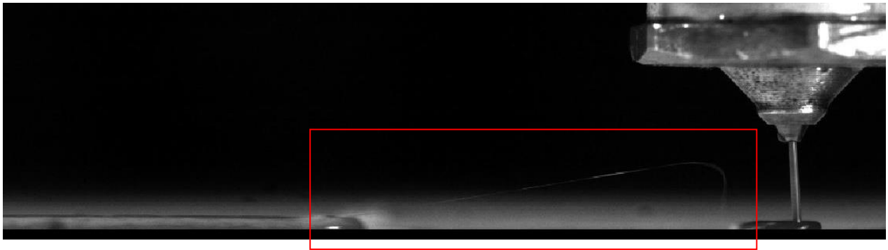
Abbildung 12 – Analyse des Fadenzugverhalten des BioGlyk-Versuchsmaterials mittels High-Speed-Videos
