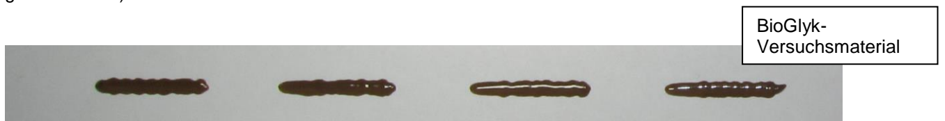
Abbildung 11 – Vergleich des BioGlyk-Versuchsmaterials mit Referenzklebstoffen: BioGlyk-Versuchsmaterial mit kleinerer Düse
