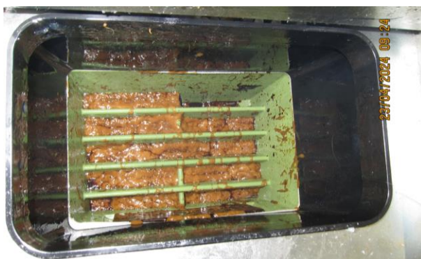
Abbildung 6 – BioGlyk-Versuchsmaterial nach ca. 6,5 Stunden auf Verarbeitungstemperatur (170°C)
