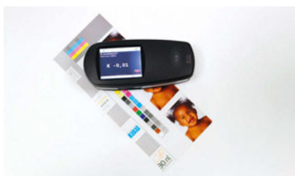
Obr. 5: Měření L*a*b* na potištěném pásku
